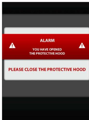
Al abrir la cubierta protectora aparecerá una pantalla de advertencia y el dispositivo emitirá un pitido continuo. El "MENÚ PRINCIPAL" reaparecerá al cerrar la cubierta.
