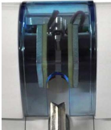
Cuando la selladora SYMS III se encuentra en funcionamiento, al retirar la cubierta de protección el aparato emitirá una señal sonora, desplegará un mensaje de advertencia en la pantalla táctil y se apagará.
